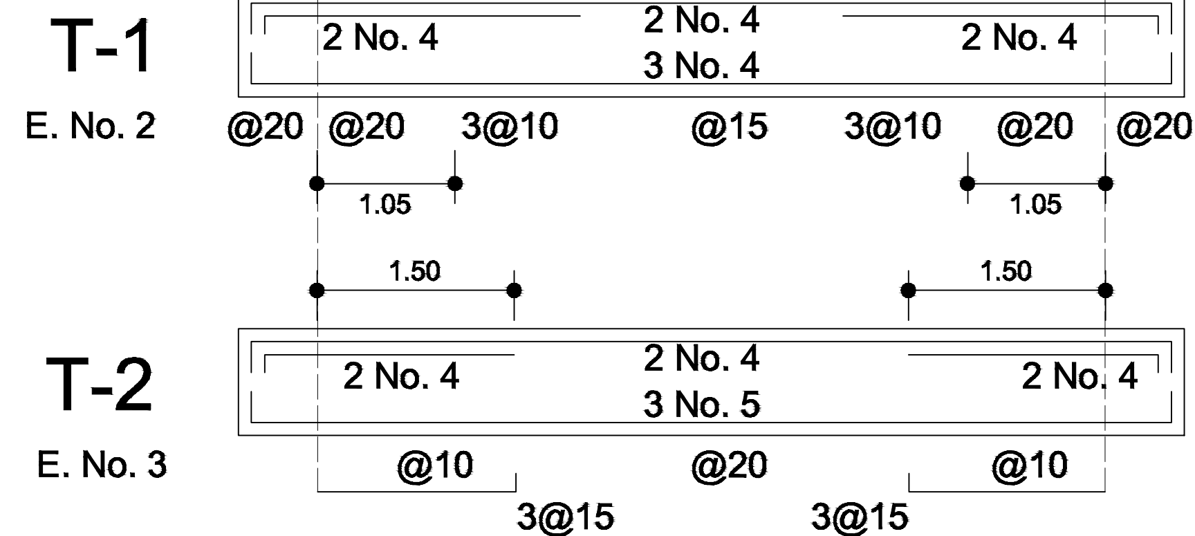
PLANTA, ARMADO LOSA DE AZOTEA ESC. 1:75
